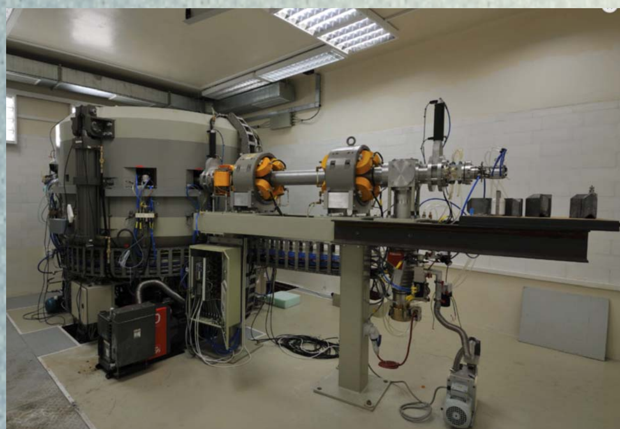
Obrázok 1 a 2 Cyklotrón vyrobený firmou IBA s urýchľovaním negatívnych iónov \text{H}^- s energiou urýchlených iónov 18 MeV
