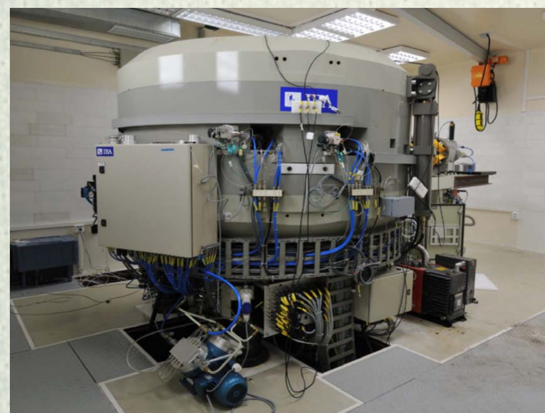
Obrázok 1 a 2 Cyklotrón vyrobený firmou IBA s urýchľovaním negatívnych iónov \text{H}^- s energiou urýchlených iónov 18 MeV
