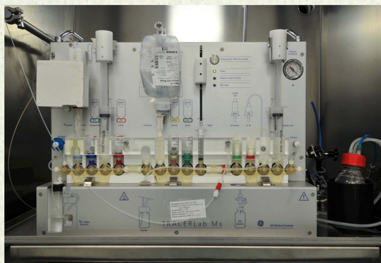
Obrázok 3 TRACERLab Mx, určený na naviazanie rádionuklidu na biologicky aktívnu látku
