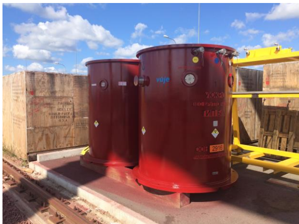
Prepravné kontajnery na tekutý rádioaktívny odpad, vyvinuté a dodané spoločnosťou VUJE pre Černobyľ
